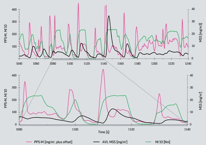
佩卡索尔M型传感器 (粉色曲线) 与AVL的MSS型微尘传感器 (黑色曲线) 的数据对比显示出其实时监测的优越性
