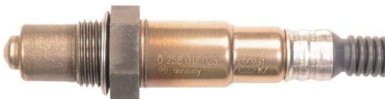
美国 ECM 公司 Lambda5220 是功能强大的新一代 Lambda/AFR/O<sub>2</sub> 分析仪，配置 CAN 接口，提供无与伦比的测量量程及精度，所有传感器均在工厂标定好，标定数据存储于连接器的存储芯片中。为提供最佳的测量精度，传感器可以在环境空气中重新快速标定，重新标定的数据同样存储于连接器存储芯片中。可选压力补偿用来提高在非理论混合气 ( $\lambda \neq 1$ ) 和非标准大气压条件下 ( $P \neq 101\text{KPa}$ ) 时的测量精度，如：压力提高 34KPa 将导致 0.58 的误差 ( $\lambda = 3$ )，压力补偿用于消除此测量误差。
